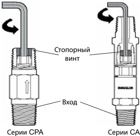
2. Продвиньте шестигранный ключ глубже в регулируемый винт
