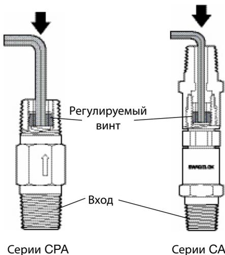
3. Вращайте оба винта по часовой стрелке, чтобы повысить давления открытия, и против часовой стрелки для его понижения.
