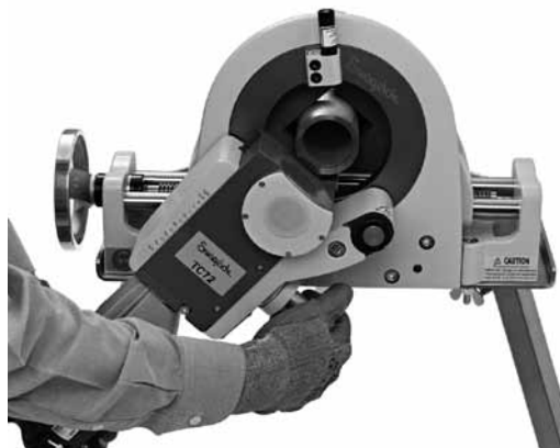
Рис. 22 Регулировка положения ножовочного полотна
