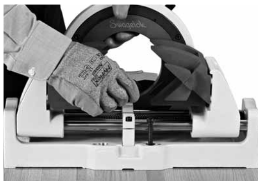
Рис. 11 Установка инструмента для резки трубок на рабочем столе
