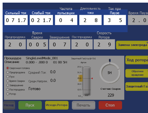
Рис. 63 — Колесики прокрутки для управления током в одноуровневом режиме
