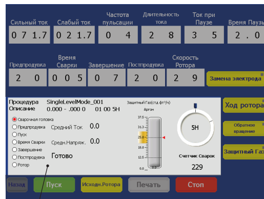
Рис. 67 — Индикаторные сигналы и экран состояния одноуровневого режима
