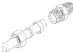
Рис. 3 Ориентация гайки и обжимных колец
