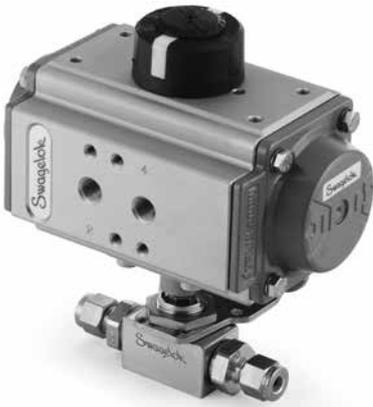
Пневматические приводы Swagelok с реечной передачей, соответствующие стандарту ISO 5211, предлагаются с режимами пружинного возврата и двойного действия.
