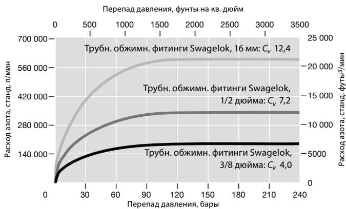
**Давление на входе 344 бар (5000 фунтов на кв. дюйм, ман.)**
