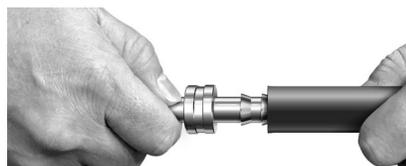
Примечание: Смазывание бороздок торцевого соединения жидким маслом (напр., 10W40) может облегчить сборку.
