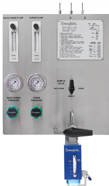
Система отбора проб с постоянным объемом
