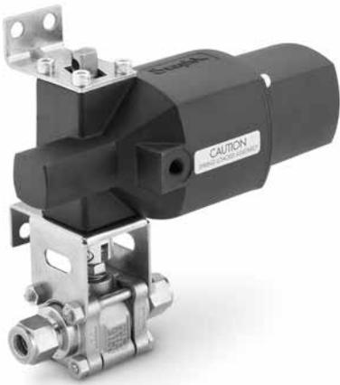
Пневматические приводы Swagelok с ременной передачей компактны, имеют малый вес, легко монтируются и могут работать со стандартным заводским источником сжатого воздуха. Предлагаются приводы с режимами пружинного возврата и двойного действия. Для двухпозиционных (2-ходовых) кранов требуется срабатывание на 90°; для переключающих (3-ходовых) кранов требуется срабатывание на 180°.
