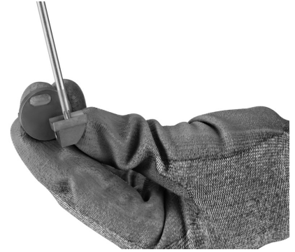
그림 12 절삭 인서트 설치
