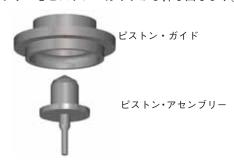
7. ピストン・アセンブリーを逆さにして、ポペット・リテイナー をバイスで固定し、**ピストン**を取り外します。
