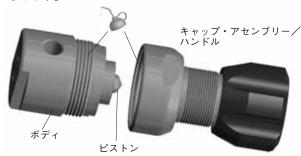
23. **キャップ・リング**を 160 N·m のトルク値で締め付けます。
