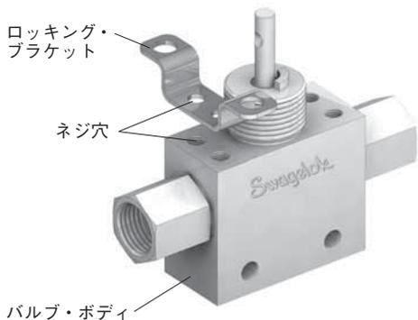
3. 2個のブラケット・ネジをバルブ・ボディに取り付け、8.5N・mのトルク値で締め付けます。
