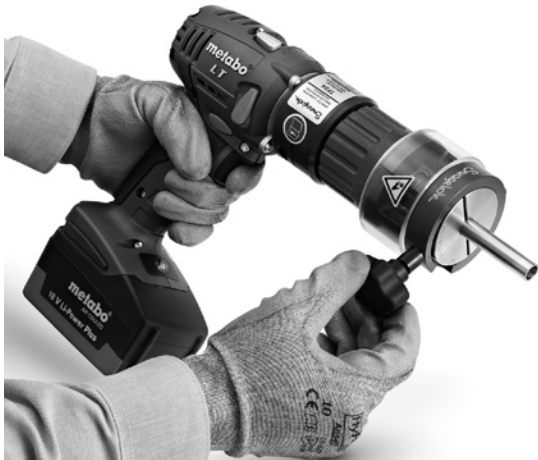
図24: チューブを固定する
