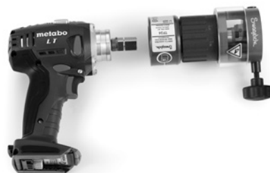
図29：コレット・ハウジングを取り外す
