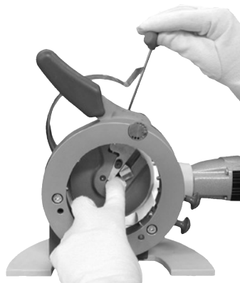
図18:インサート・ホルダーを横方向に挿入する
