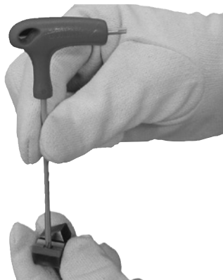
図17:TFカutting・インサート (MS-TF-BIT) をインサート・ホルダーにねじ込む
