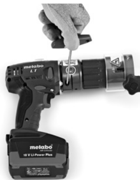
図28：止めネジを緩める
