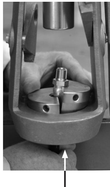
12. かしめを行ったアセンブリーを固定し、ダイをハウジングから取り外します。かしめを行ったアセンブリーをハウジング底部から取り外します。
