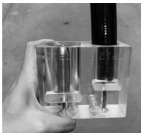
先のとがった油性鉛筆を使用して、ホース (挿入深さ確認ゲージにできるだけ近い部分) にマークを付けます。
