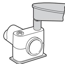
手順3B：トルク・レンチを使用して、各スタッキング・ボルトを最大7.9N・mのトルク値で締め付けます。アセンブリーの両サイドで締め付け度と同じになるよう、締め付けは交互に行ってください。
