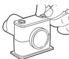
手順5：六角ヘッド・ボルトをカバー・プレートおよびボディ・アセンブリーに差し込み、指締めします。
