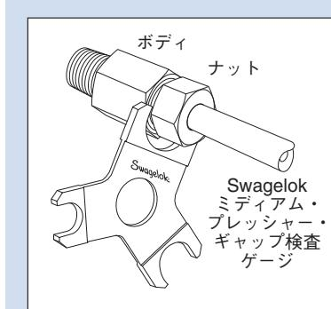
Swagelok ミディアム・プレッシャー・ギャップ検査ゲージを使用することで、継手が十分に締め付けられているかどうかを確認することができます(初回取り付け時)。
