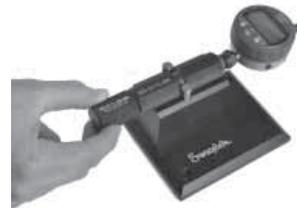
品質コントロールの要件に合わせて、フェルールの位置や予備締めストロークを確認することができるゲージ・キット (オプション、サイズ：1/4 インチおよび 6 mm) もございます。
