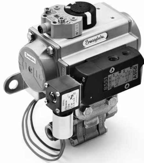
ISO 5211 準拠のアクチュエーター、ASCO® ソレノイド・バルブ、Pepperl+Fuchs 社製近接センサー付きの Swagelok 63 シリーズ・バルブ
