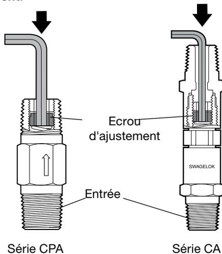
3. Tournez les deux écrous dans le sens des aiguilles d'une montre pour augmenter la pression d'ouverture, et dans le sens inverse des aiguilles d'une montre pour diminuer la pression d'ouverture.
