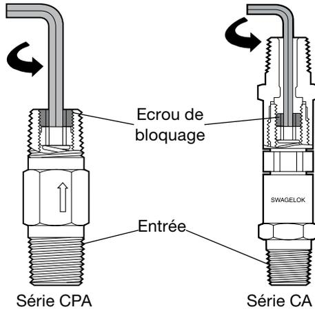
2. Insérez la clé hexagonale à l'intérieur de l'écrou d'ajustement.
