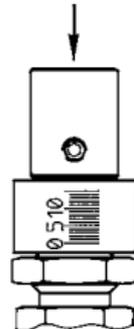
**ÉTAPE 4** Desserrez la **vis de l'extension de tige** et faites glisser l'**extension** vers le bas contre le **tourillon**, tout en maintenant la tige dans sa position. Serrez à nouveau la **vis de l'extension de tige**. Une butée fixe est maintenant réglée pour la poignée.
