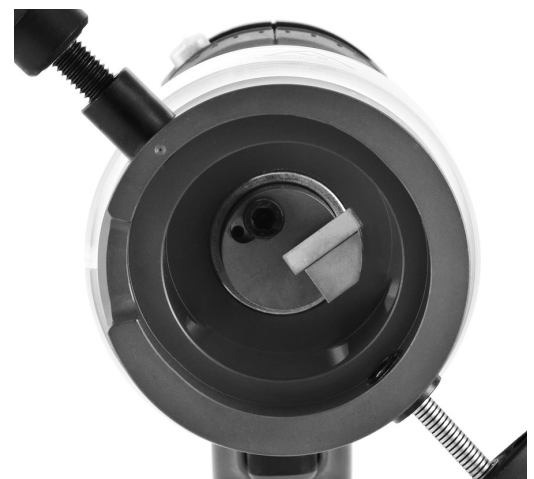
Fig. 13 : Installation du porte-outil, séries TF16 et TF24
