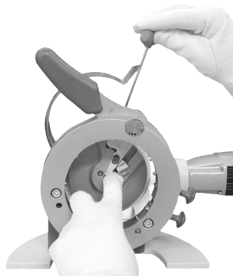
Fig. 18 : Insérer le porte-outil par le côté
