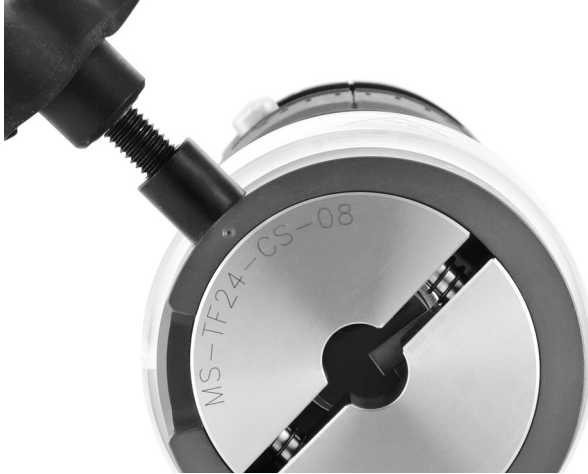
Fig. 14 : Introduire le collet dans le corps
