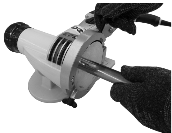
Fig. 21 : Blocage du tube sur la machine TF48
