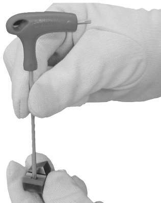
Fig. 17 : Visser l'outil de coupe MS-TF-BIT sur le porte-outil
