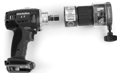
Fig. 31 : Dépose de la partie de l'outil comportant le logement du collet
