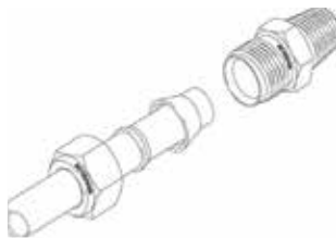
Figure 3 : Orientation de l'écrou et des bagues
