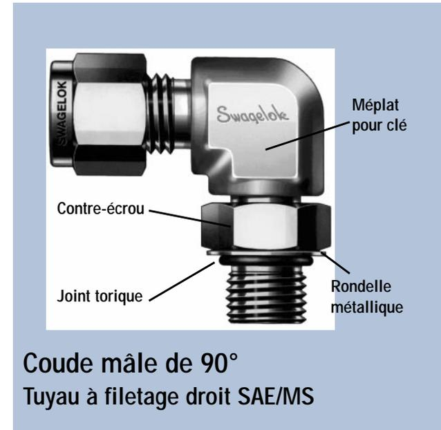
3. Placez le raccord en le retirant (pas plus d'un tour dans le sens inverse des aiguilles d'une montre) jusqu'à ce l'extrémité du raccord à tube Swagelok soit orientée dans la bonne direction
