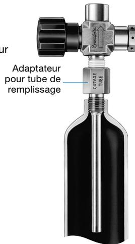
Les tubes de remplissage peuvent aussi être soudés à l'entrée mâle d'une vanne à pointeau Swagelok à tige non rotative. La vanne est ensuite vissée dans l'orifice femelle d'un cylindre d'échantillonnage.
