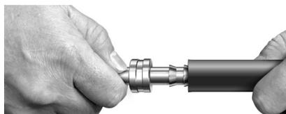
Remarque : l'assemblage pourra être facilité en lubrifiant les barbelures avec une huile de type 10W40.
