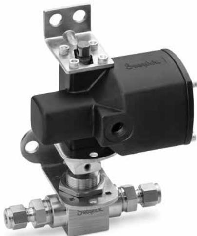
Les actionneurs pneumatiques Swagelok à pignon/crémaillère sont compacts, légers, faciles à monter, et peuvent fonctionner avec le réseau d'air de l'atelier. Ils sont disponibles en modes retour par ressort et double effet. Les vannes tout ou rien (2 voies) nécessitent un actionnement à 90° ; les vannes de commutation (3 voies) nécessitent un actionnement à 180°.
