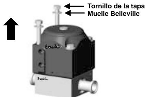
4. Retire el conjunto del actuador del cuerpo de la válvula.
