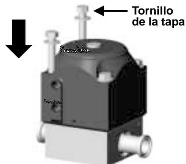
6. Apriete los **tornillos de la tapa** con una llave dinamométrica en una serie de tres secuencias como se indica en la tabla siguiente. En cada pasada, cambie de un tornillo a otro siguiendo un recorrido en forma cruzada.
