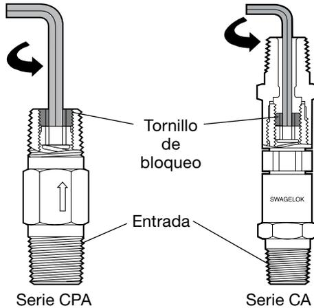
2. Introduzca la llave hexagonal por el tornillo de bloqueo hasta el **tornillo de ajuste**
