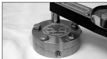
Apriete los pernos con la llave dinamoétrica hasta 120 pulg.-lb. Hágalo en secuencia cruzada y aumente el par de cada perno gradualmente hasta que todos estén apretados a 120 pulg.-lb. Si no hay etiqueta en el filtro, extraiga una del protector y adhiérela a la carcasa del filtro.
