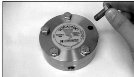
Los pernos de acero inoxidable se suministran lubricados. Si es necesario, lubrique ligeramente la mitad inferior de cada perno para reponer la posible pérdida de lubricación. Si hay exceso de lubricante, elimínelo antes de instalarlos.
