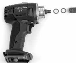
Fig. 33 Tuerca de transmisión desmontada
