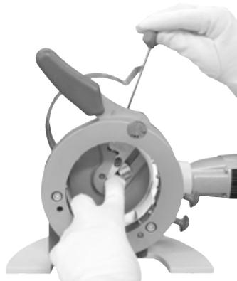
Fig. 18 Instale lateralmente el Soporte de las Cuchillas
