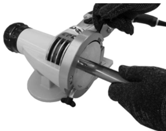
Fig. 21 Sujetar el Tubo en la TF48
