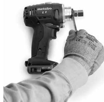
Fig. 32 Retirar la tuerca de transmisión
