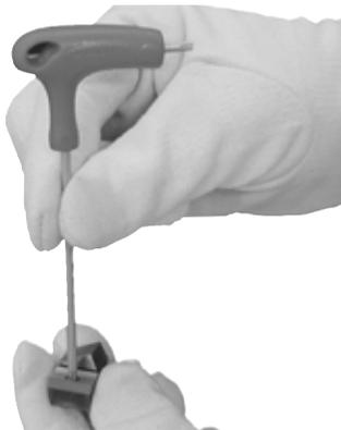
Fig. 17 Rosque la MS-TF-BIT en el Soporte de las Cuchillas
