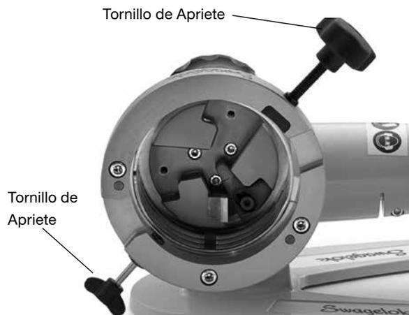
Fig. 20 Montaje y Sustitución de la Carcasa de Sujeción TF48
