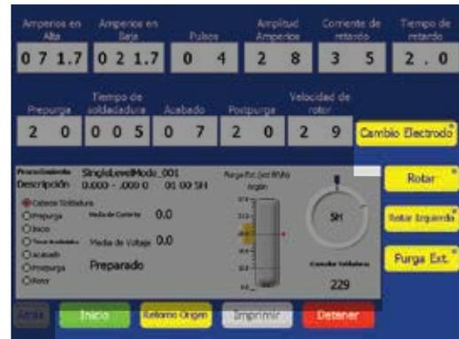
Fig. 65—Botones del proceso de soldadura en nivel único
