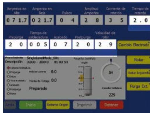
Fig. 64—Modo 1 Nivel-Selectores de control de tiempo
