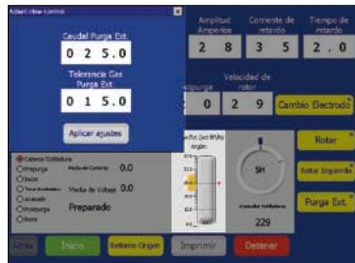
Fig. 66—Cuadro desplegable de ajuste del caudal del purga ext. en nivel único
