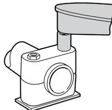
Paso 3B – Con una llave dinamométrica, apriete cada uno de los tornillos de apilamiento con un par de torsión máximo de 7,9 N{m (70 pulg. {lb). Al apretar los tornillos, hágalo de forma alternada, para que vayan tirando uniformemente del conjunto por ambos lados.
