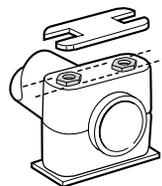
Paso 3C – Alinee los tornillos de apilamiento de modo que las caras planas hexagonales queden bien colocadas para recibir la placa de fijación.
