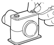
Paso 5. Inserte los tornillos de cabeza hexagonal a través de la tapa y del conjunto del cuerpo del soporte. Apriételes firmemente.
