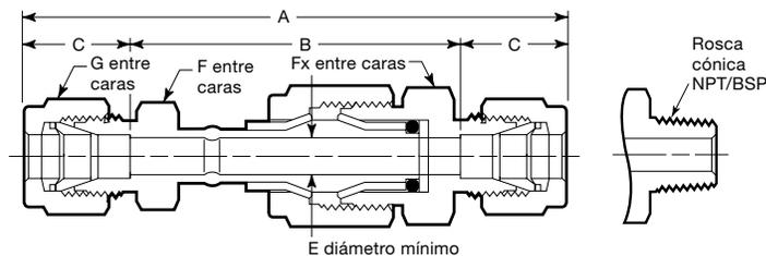
**Precaución:** No desmonte la conexión de aislamiento. Debe evitar que se rompa, y no puede utilizarse como un punto de desconexión.
