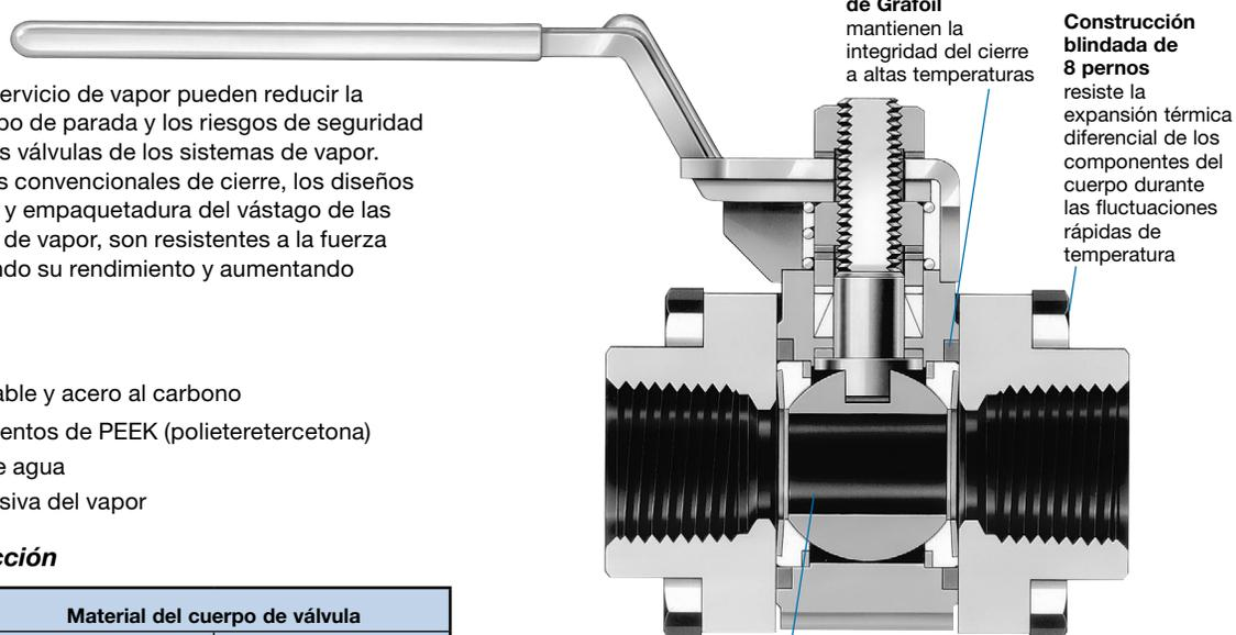
Las válvulas de bola serie 60 para servicio de vapor, tienen un orificio inferior al de las válvulas estándar, para mejorar el rendimiento del cierre durante ciclos térmicos. La siguiente tabla muestra los  $C_v$  máximos de las válvulas para servicio de vapor. El usuario debe comparar estos valores de  $C_v$  con los de las conexiones finales en las tablas anteriores, para comprobar si el  $C_v$  máximo se ve reducido.
