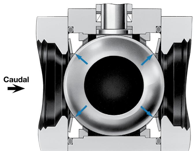
En condiciones de alta presión, la bola es forzada aguas abajo, causando la flexión del asiento y la creación del cierre. El movimiento de la bola también causa la flexión de su asiento aguas arriba y mantiene el cierre estanco.
