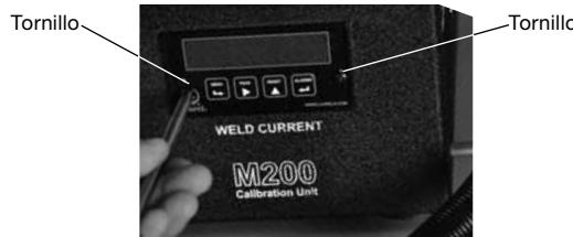
Fig. 12 — Tornillos del panel visor
