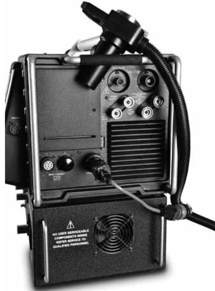
Fig. 9 – Raccordements pour la vérification de la vitesse représentés avec le câble adaptateur de tête à souder optionnel
