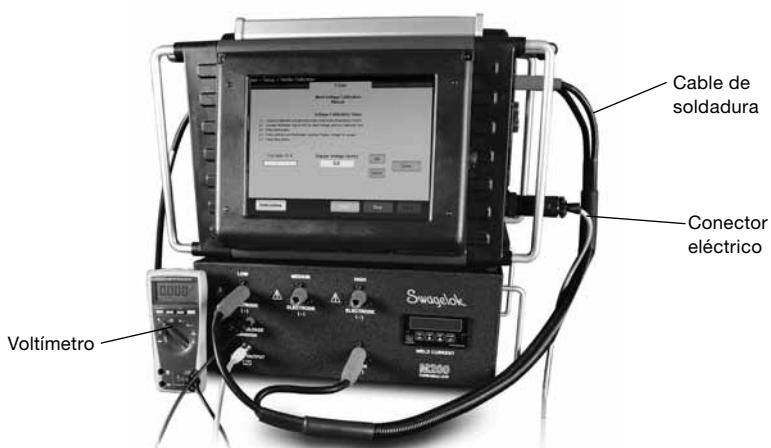
Fig. 7 – Conexiones de calibración del voltaje
