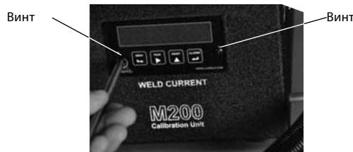
Рис. 12 — винты панельного измерительного блока
