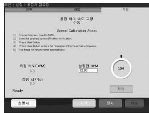
그림 8 – 속도 탭(Speed Tab)
