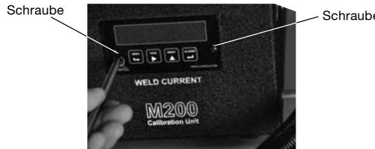
Abb. 12 – Schrauben am eingebauten Messgerät
