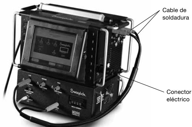
Fig. 1 – Conexiones de puesta en marcha
