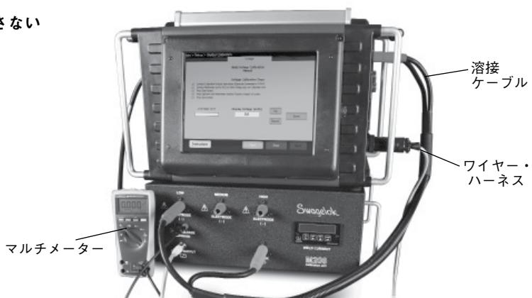
図7—電圧校正時の接続
