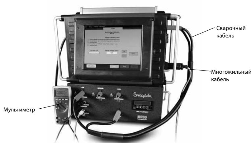
Рис. 7 — соединения для калибровки напряжения
