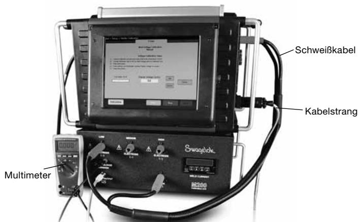
Abb. 7 – Anschlüsse zur Spannungskalibrierung
