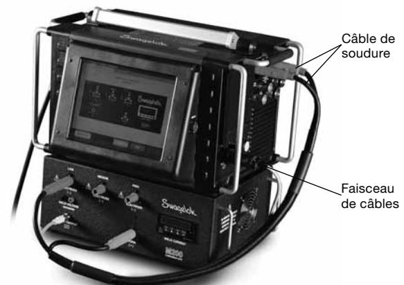
Fig. 1 — Raccordements de réglage
