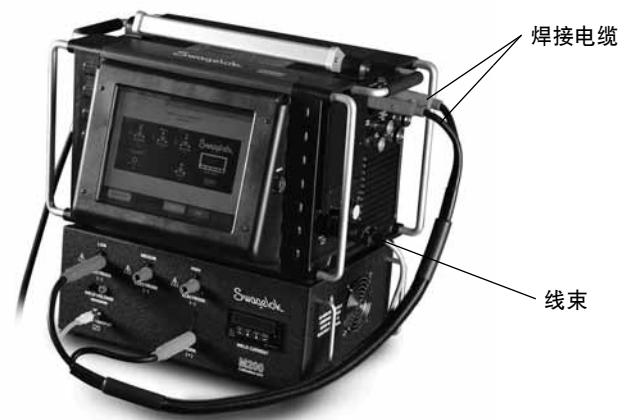
图 1 – 安装连接
