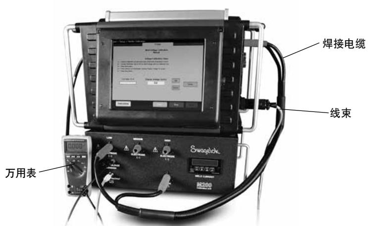
图 7 – 电压校准连接
