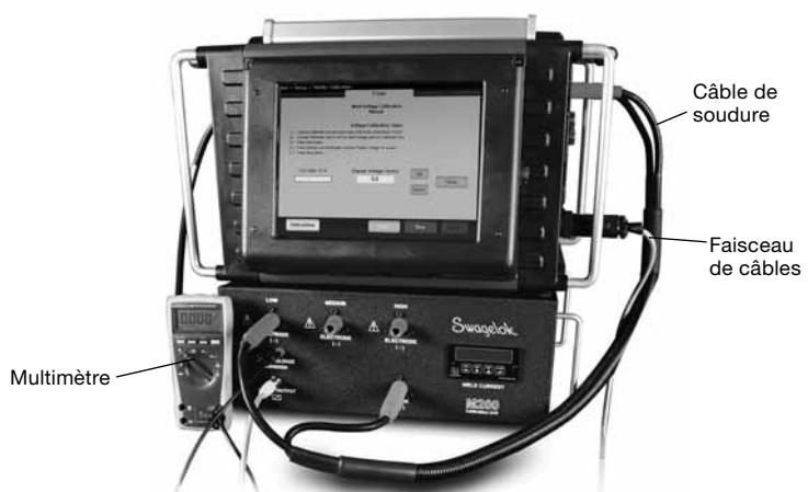
Fig. 7 – Branchements pour l'étalonnage de la tension
