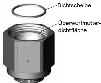
7. Die **Überwurfmutter** auf den **Körper** aufschrauben, bis das Körpergewinde nicht mehr sichtbar ist.
