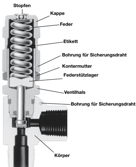
1. Kontermutter lösen und die Kappe vom Ventilhals entfernen.
