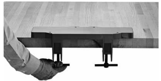
Abb. 12 Montieren einer Schnellmontageplatte
