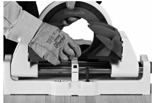
Abb. 11 Befestigen des Rohrschneidwerkzeugs an der Werkbank
