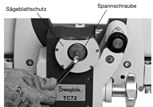
Abb. 19 Position 2 der Sägeblattzähne
