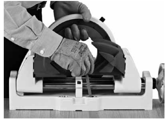
Abb. 10 Markieren von Bohrungslöchern auf der Werkbank
