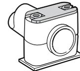
Schritt 3D. Legen Sie die Sicherungsplatte auf die Schelleneinheit und die Aufbauschrauben.
