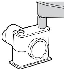
Schritt 6. Ziehen Sie die Schrauben mit einem Drehmoment von maximal 7,9 N•m (70 Zoll•lb.) fest. Ziehen Sie die Schrauben im Wechsel an, um ein gleichmäßiges Anziehen auf beiden Seiten der Anordnung sicherzustellen.
