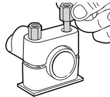
Schritt 3A – Setzen Sie die Sechskant-Aufbauschrauben durch die Schelleneinheit ein. Ziehen Sie die Schrauben fingerfest an.
