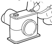
Schritt 5. Führen Sie die Sechskantschrauben durch die Deckplatte und die Schelleneinheit. Ziehen Sie die Schrauben fingerfest an.
