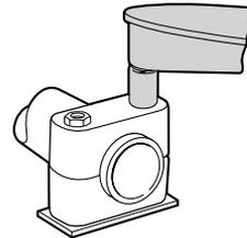
Schritt 3B – Ziehen Sie die Aufbauschrauben mit Hilfe eines Drehmomentschlüssels mit einem Drehmoment von maximal 7,9 N•m (81 cm•kg, 70 in.•lb.) fest. Ziehen Sie die Schrauben im Wechsel an, um ein gleichmäßiges Anziehen auf beiden Seiten der Anordnung sicherzustellen.
