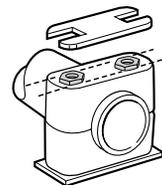
Schritt 3C – Aufbauschrauben ausrichten, so dass die Sicherungsplatte aufgesetzt werden kann.
