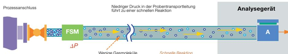
Die Menge des Gases, die sich in der Transportleitung befindet, ist proportional zu dessen Absolutdruck. Bei der Hälfte des Absolutdrucks befinden sich halb so viele Gasmoleküle in der Leitung, daher braucht eine frische Probe—sofern alle anderen Variablen unverändert sind—halb so lange, um zum Analysegerät zu gelangen.
