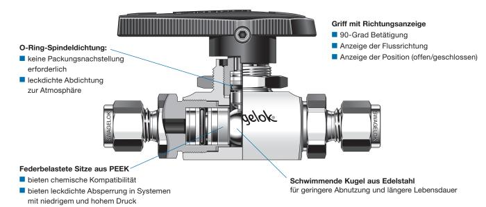
Die Kugelhähne der Serie SK von Swagelok® bieten eine 90°-Betätigung mit geringem Drehmoment in einer kompakten Konstruktion und bieten eine sichere Absperrung bei Anwendungen bis zu 413 bar (6000 psig). Weitere Merkmale:
