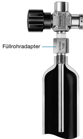
Füllrohre können auch direkt an den Eingang mit Außengewinde eine Swagelok Absperrventils mit nichtdrehender Spindel angeschweißt werden. Das Ventil wird dann in den Anschluss mit Innengewinde eines Probeentnahmezylinders geschraubt.
