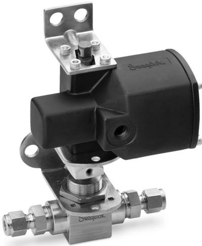
Pneumatische Steuerköpfe von Swagelok sind kompakt, leicht und einfach zu montieren. Die Steuerköpfe sind mit Federrückholung und Doppelbetätigung erhältlich. Hähne in gerader Ausführung, in Winkelausführung und 4-Wege-Hähne erfordern eine Betätigung von 90°; 3-Wege-Hähne erfordern eine Betätigung von 180°.
