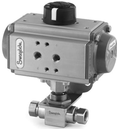
Diese pneumatischen Steuerköpfe von Swagelok entsprechen den Anforderungen von ISO 5211 und sind für allgemeine Anwendungen geeignet. Sie sind mit Federrückholung und Doppelbetätigung erhältlich. Auf-/Zu- (2-Wege) Hähne erfordern eine Betätigung von 90°; Umschalt- (3-Wege) Hähne erfordern eine Betätigung von 180° (90° Betätigung für Hähne mit L-Bohrung).
