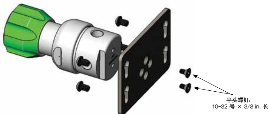
KPR 调压阀和支架安装
