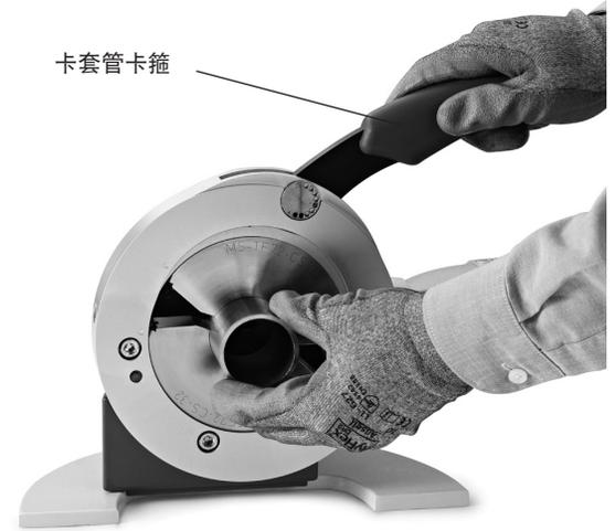
图 14 夹紧卡套管
