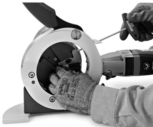
图7 安装工具支架
