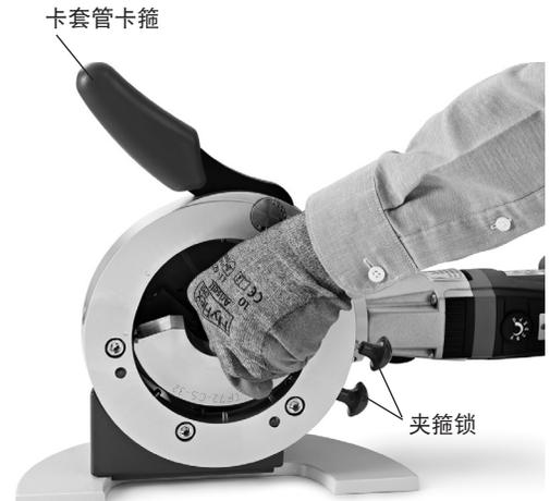
图9 安装下夹箍
