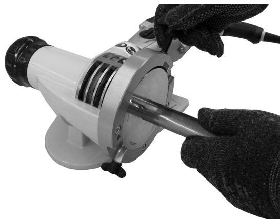
图 21 夹紧 TF48 的卡套管
