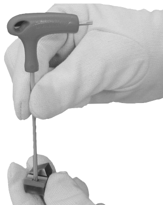
图 17 将 MS-TF-BIT 拧到工具支架上
