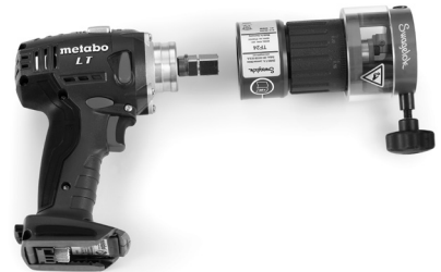
图 31 拆卸车刀的夹箍外壳部分
