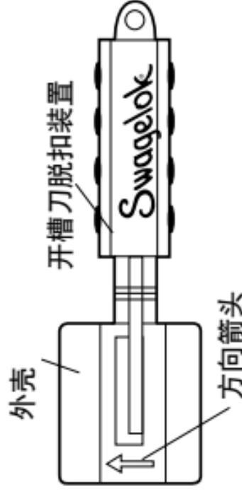
为了确保正确的密封，PFA管上的切槽必须与管轴垂直，并且没有碎屑、毛刺以及断口。
