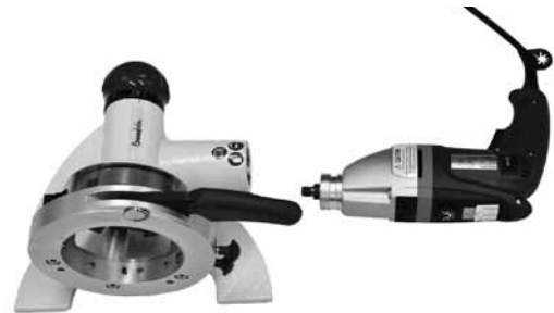
Fig. 17 Retirar el bloque de la carcasa del collarín de la herramienta
