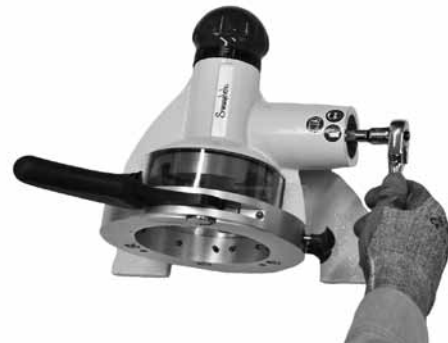
Fig. 18 Retirar la tuerca de transmisión
