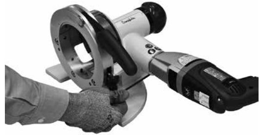
Fig. 16 Aflojar el tornillo de ajuste
