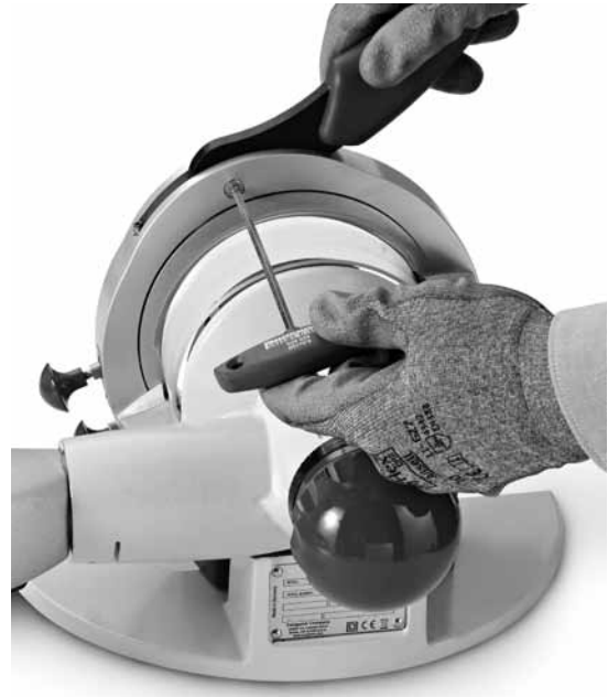
Fig. 13 Aflojar el tornillo
