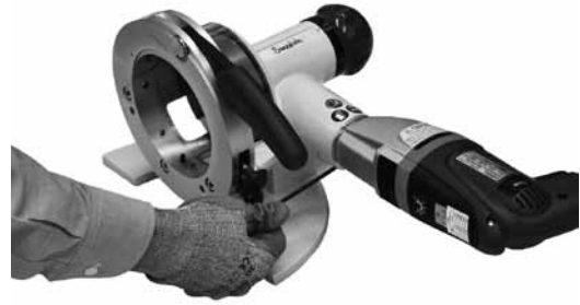
Fig. 16 Aflojar el tornillo de ajuste
