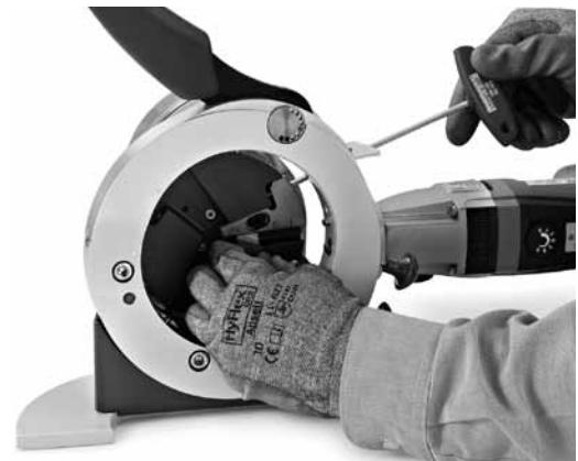
Fig. 7 Instalar el soporte de la cuchilla
