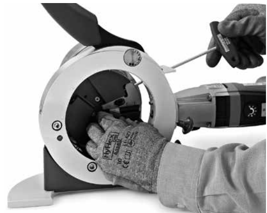
Fig. 7 Instalar el soporte de la cuchilla
