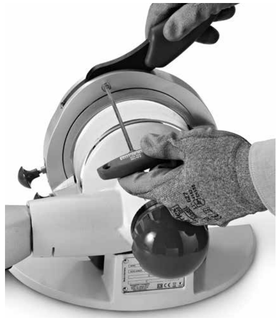
Fig. 13 Aflojar el tornillo
