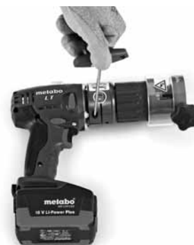
Рис. 32 Ослабление установочного винта
