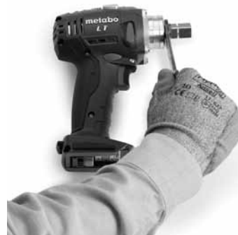
Рис. 34 Извлечение разъединительной гайки
