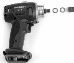
Рис. 35 Разъединительная гайка, извлеченная из инструмента
