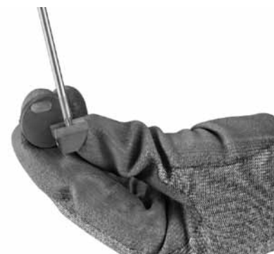
Рис. 12 Установка режущей вставки
