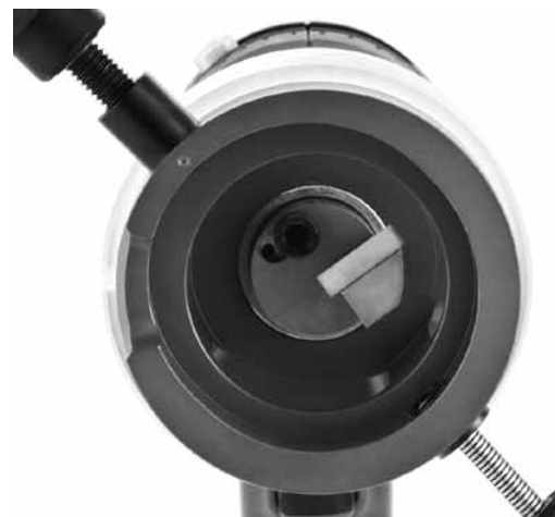
Рис. 13 Установка держателя инструмента, серии TF16 и TF24
