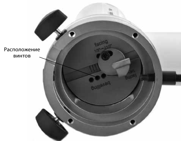
Рис. 14 Установка держателя инструмента, серия TF40
