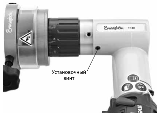
Рис. 31 Установочный винт положения корпуса
