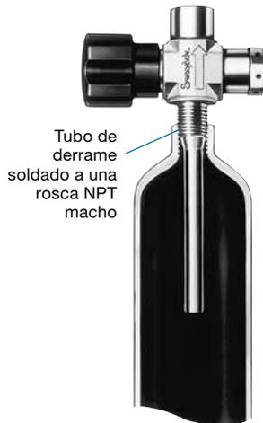
Los tubos de derrame también se pueden soldar directamente a la entrada macho de una válvula de aguja Swagelok con obturador no giratorio. Y la válvula se rosca entonces en la conexión hembra del cilindro de toma de muestra.
